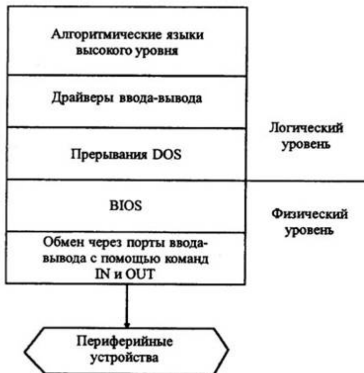
Рис. 11.7. Логический и физический уровни интерфейсов ввода-вывода
