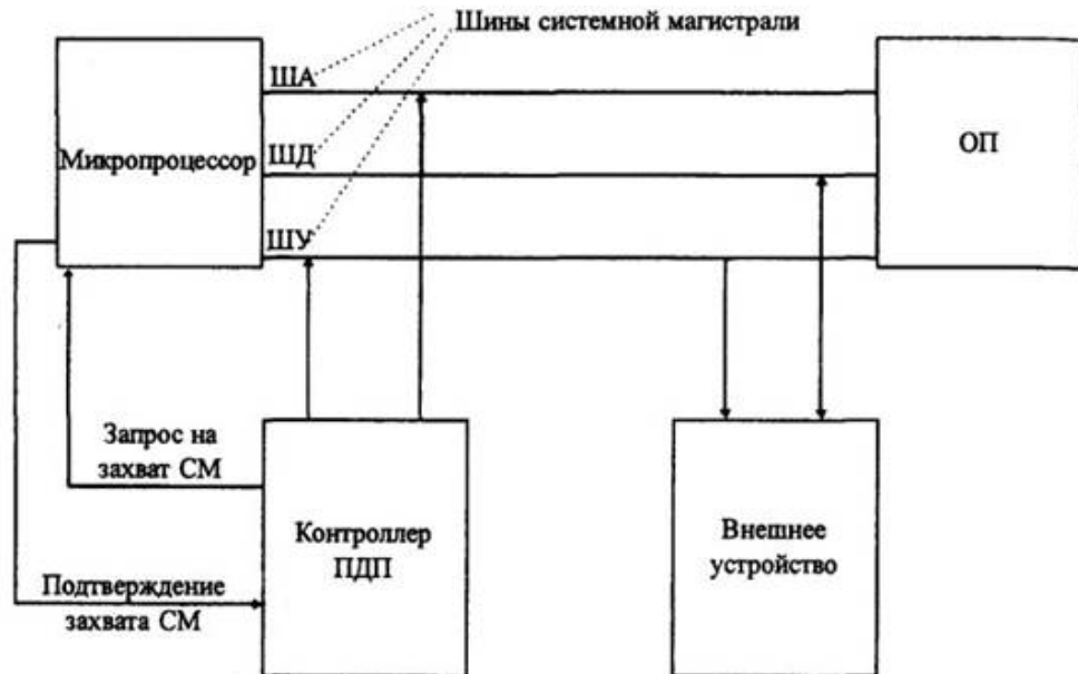
Рис. 11.9. Взаимодействие устройств в режиме прямого доступа к памяти
