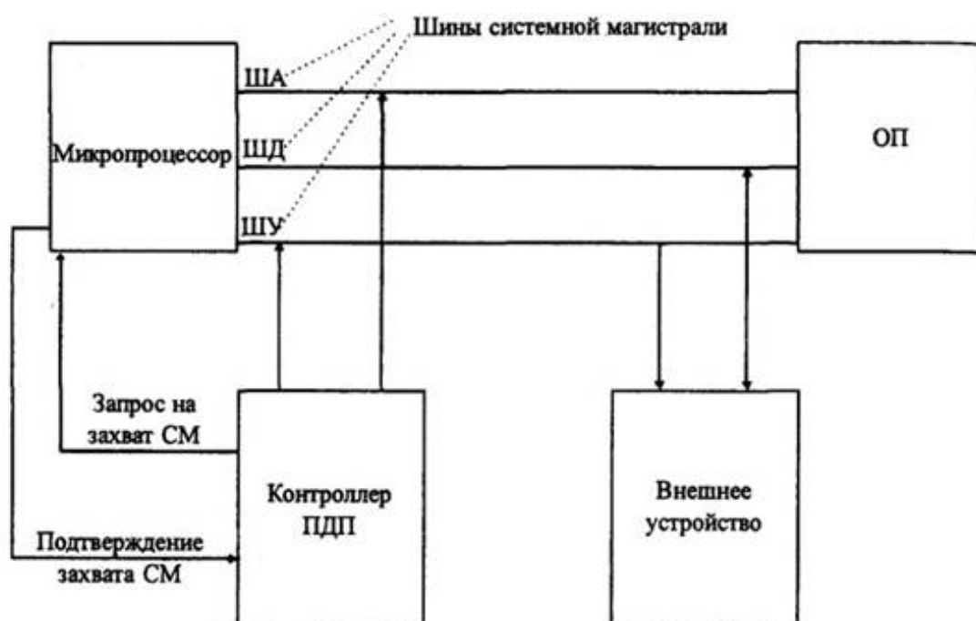
Рис. 6.8. Взаимодействие устройств в режиме прямого доступа к памяти
