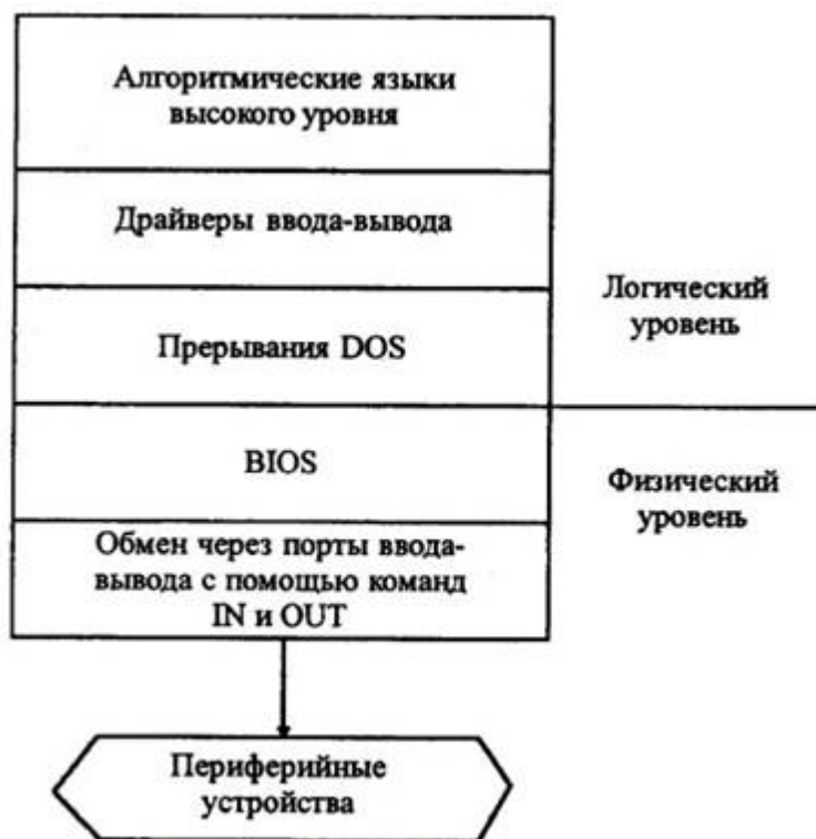
Рис. 6.6. Логический и физический уровни интерфейсов ввода-вывода
